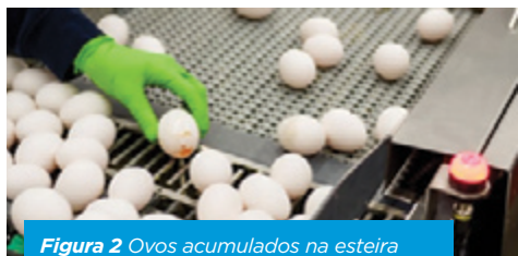
Figura 2 Ovos acumulados na esteira aumentarão a quantidade de trincados.
