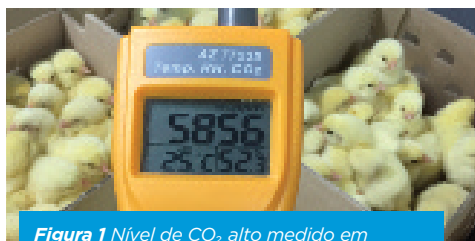
Figura 1 Nível de CO 2 alto medido em uma sala de alojamento com ventilação suficiente.
