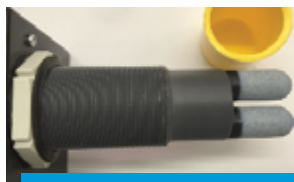
Figura 2 A fotografia acima mostra sensores de CO 2 típicos em um nascedouro, protegido pelas capas de proteção dos sensores. Se as capas ficam entupidas com pó ou condensação, o sensor fará uma leitura artificialmente alta.
