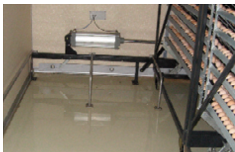
Figura 1 Água quieta no piso de um nascedouro de estágio único no final do período selado.
